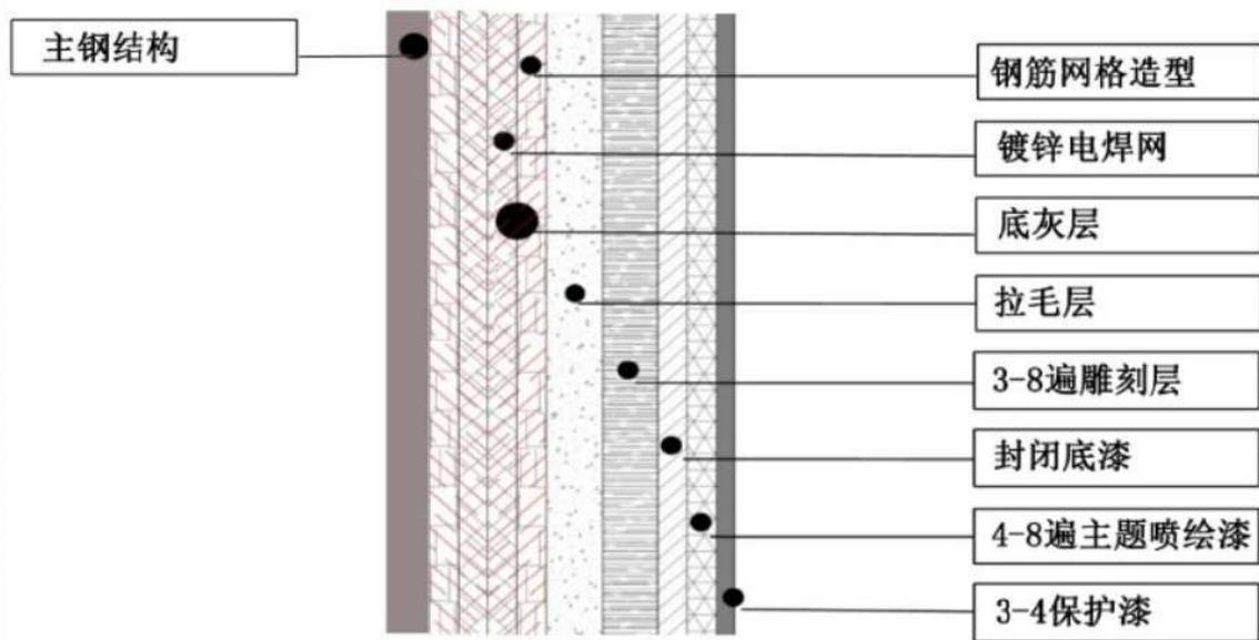
①主钢结构 → ②钢筋网格造型 → ③镀锌电焊网 → ④底灰层 → ⑤拉毛层
